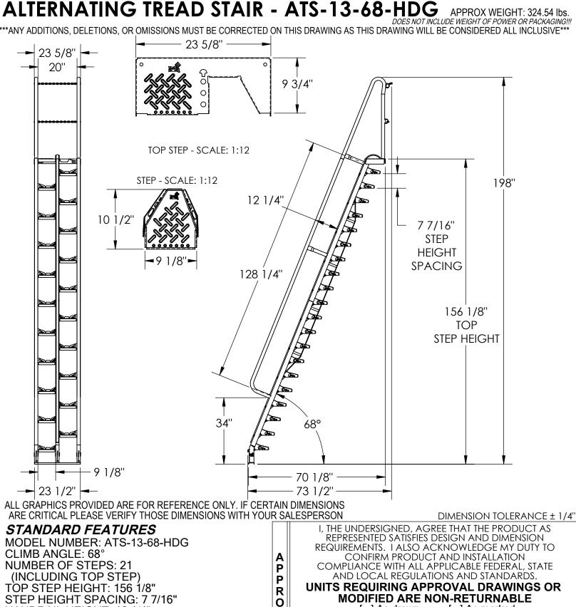
NUMBER OF STEPS: 21 STEP HEIGHT SPACING: 7 7/16" HANDRAIL HEIGHT: 12 1/4" **OVERALL HEIGHT: 198'**
