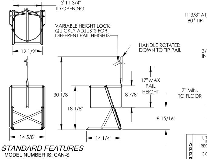
MODEL NUMBER IS: CAN-S OVERALL WIDTH IS: 14 5/8" OVERALL LENGTH IS: 14 1/4" OVERALL HEIGHT IS: 30 1/8"
