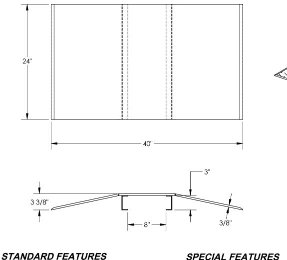
MODEL NUMBER IS FHCR-24-40-8-BK CAPACITY: 2,000 LBS. **OVERALL WIDTH IS 24" OVERALL LENGTH IS 40" OVERALL HEIGHT IS 3 3/8"** USABLE SPAN IS 8" WIDE x 3" HIGH MATERIAL: ALUMINUM TREADPLATE TOUGH BAKED IN POWDER COATED **BLACK FINISH**
