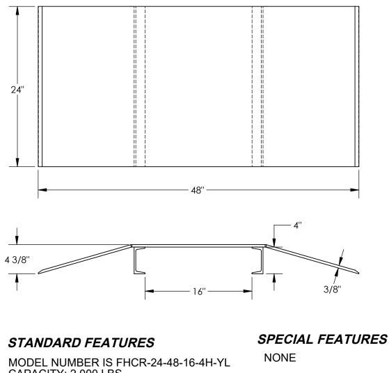
CAPACITY: 2.000 LBS. **OVERALL WIDTH IS 24" OVERALL LENGTH IS 48" OVERALL HEIGHT IS 4 3/8"** USABLE SPAN IS 16" WIDE x 4" HIGH MATERIAL: ALUMINUM TREADPLATE TOUGH BAKED IN POWDER COATED YELLOW FINISH
