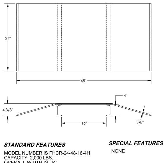
**OVERALL WIDTH IS 24" OVERALL LENGTH IS 48" OVERALL HEIGHT IS 4 3/8"** USABLE SPAN IS 16" WIDE x 4" HIGH
