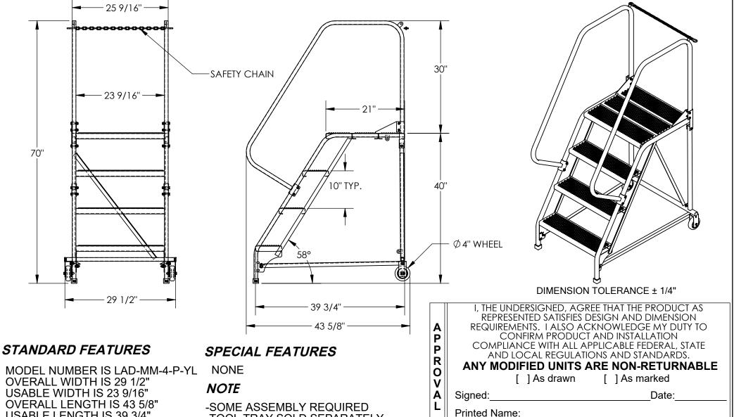
**OVERALL WIDTH IS 29 1/2"** USABLE WIDTH IS 23 9/16" **OVERALL LENGTH IS 43 5/8" USABLE LENGTH IS 39 3/4" OVERALL HEIGHT IS 70"** PLATFORM HEIGHT IS 40"
