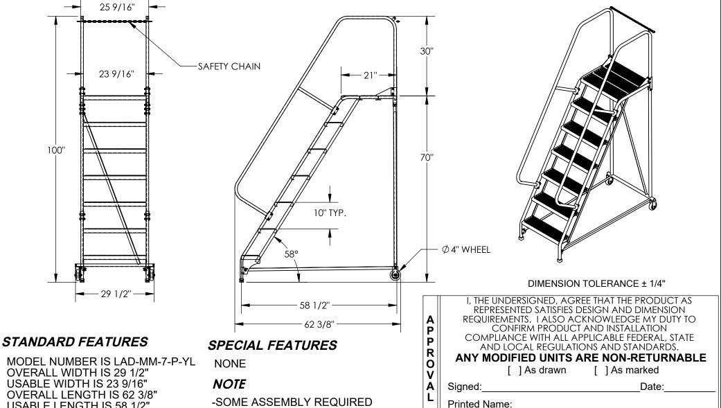
OVERALL WIDTH IS 29 1/2" USABLE WIDTH IS 23 9/16" **OVERALL LENGTH IS 62 3/8" USABLE LENGTH IS 58 1/2" OVERALL HEIGHT IS 100"** PLATFORM HEIGHT IS 70"
