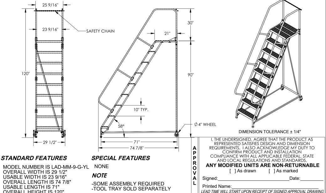
**OVERALL HEIGHT IS 120"** PLATFORM HEIGHT IS 90" TOUGH BAKED IN POWDER COATED YELLOW FINISH STEP TYPE: GRIP STRUT STEPS CLIMB ANGLE: 58°
