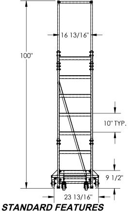
MODEL NUMBER IS LAD-PW-18-7-P OVERALL WIDTH IS 23 13/16" NOTE USABLE WIDTH IS 16 13/16" **OVERALL LENGTH IS 56 1/4"** USABLE LENGTH IS 51 1/2" OVERALL HEIGHT IS 100" PLATFORM HEIGHT IS 70" STEP TYPE IS PERFORATED SPECIAL FEATURES CLIMB ANGLE IS 58° NONE STEP DEPTH IS 7" PLATFORM DEPTH IS 14" COLOR IS TOUGH BAKED IN POWDER COATED BLUE FINISH BOTTOM STEP TOUGH BAKED IN POWDER COATED YELLOW FINISH MAX CAPACITY IS 350 LBS FRONT WHEEL IS SWIVEL, SIZE IS Ø 3" REAR WHEEL IS RIGID, SIZE IS Ø 4"
