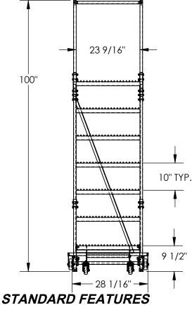
MODEL NUMBER IS LAD-PW-26-7-G OVERALL WIDTH IS 28 1/16" NOTE USABLE WIDTH IS 23 9/16" OVERALL LENGTH IS 56 5/16" USABLE LENGTH IS 51 1/2" OVERALL HEIGHT IS 100" PLATFORM HEIGHT IS 70" STEP TYPE IS GRIP STRUT CLIMB ANGLE IS 58° NONE STEP DEPTH IS 7" PLATFORM DEPTH IS 14" TOUGH BAKED IN POWDER COATED BLUE FINISH BOTTOM STEP IS TOUGH BAKED IN POWDER COATED YELLOW FINISH MAX CAPACITY IS 350 LBS FRONT WHEEL IS SWIVEL. SIZE IS Ø 3" REAR WHEEL IS RIGID, SIZE IS Ø 4"
