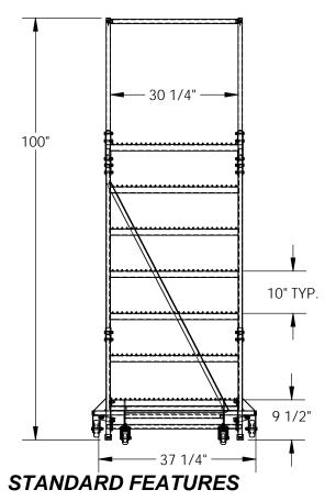
MODEL NUMBER IS LAD-PW-32-7-G OVERALL WIDTH IS 37 1/4" USABLE WIDTH IS 30 1/4" **OVERALL LENGTH IS 56 1/4" USABLE LENGTH IS 51 1/2" OVERALL HEIGHT IS 100"** PLATFORM HEIGHT IS 70" STEP TYPE IS GRIP STRUT CLIMB ANGLE IS 58° STEP DEPTH IS 7" PLATFORM DEPTH IS 14" **COLOR IS VESTIL BLUE BOTTOM STEP COLOR IS YELLOW** MAX CAPACITY IS 350 LBS FRONT WHEEL IS SWIVEL, SIZE IS Ø 3" REAR WHEEL IS RIGID, SIZE IS Ø 4"
