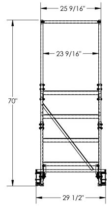
STANDARD FEATURES MODEL NUMBER IS LAD-TRN-50-4-FDA OVERALL WIDTH IS 29 1/2" USABLE WIDTH IS 23 9/16" **OVERALL LENGTH IS 47"** USABLE LENGTH IS 41 1/2" **OVERALL HEIGHT IS 70"** PLATFORM HEIGHT IS 40" STEP TYPE IS PERFORATED CLIMB ANGLE IS 50° STEP DIMENSION IS 24" x 7" TOP STEP DIMENSION IS 24" x 14" MAX CAPACITY IS 350 LBS TOUGH BAKED IN POWDER COATED FDA COMPLIANT WHITE FINISH
