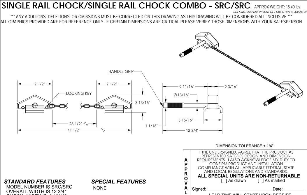
CHOCK WIDTH IS 3 15/16" **OVERALL LENGTH IS 41 1/2"** CHOCK LENGTH IS 7 1/2" EACH END **OVERALL HEIGHT IS 3 13/16"**
