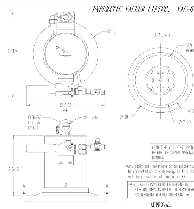
DETAIL A-A SEAL BARRIER Ø 8 1/2 Ø 10
